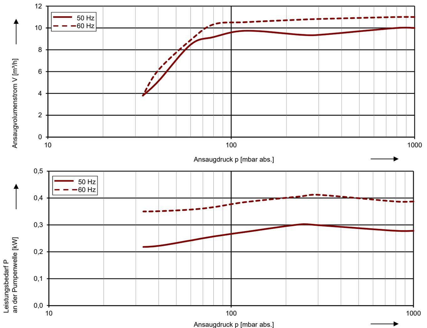
Die Kennlinien gelten bei Ansaugen von Luft mit 100 % relativer Feuchte und ein Ansaugtemperatur von 20 °C. Bei einem Atmosphärendruck von 1013 mbar abs. und einer Betriebsflüssigkeitstemperatur von 15 °C (Wasser als Betriebsflüssigkeit) werden die Kennliniendaten eingehalten. Die Toleranz beträgt ± 10 %.
